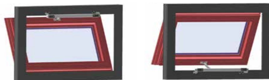
Kippflügel / Klappflügel nach außen öffnend; Bottom hung window / Top hung window outward opening; Antrieb oben / unten mittig am Rahmen an der Hauptschließkante Actuator top / bottom middle on frame at the main closing edge
