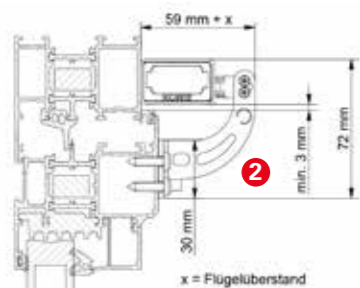
Kippflügel / Klappflügel nach innen öffnend; Bottom hung window / Top hung window inward opening; Antrieb oben / unten mittig am Rahmen an der Hauptschließkante Actuator top / bottom middle on frame at the main closing edge
