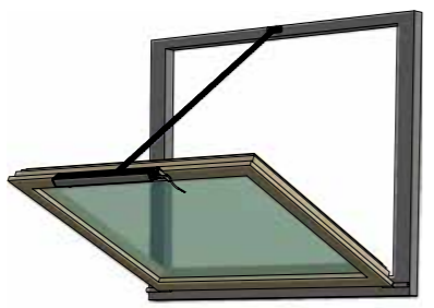
Kippflügel nach innen öffnend; Antrieb oben mittig am Flügel an der Hauptschließkante Bottom hung window inward opening; Actuator top middle on sash at the main closing edge
