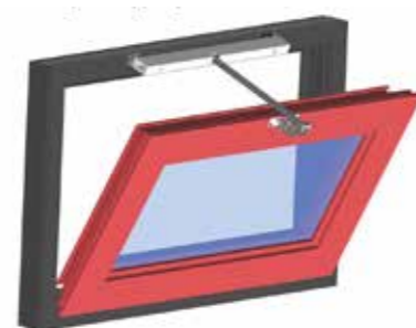
Kippflügel nach innen öffnend; Bottom hung window inward opening; Antrieb oben mittig am Rahmen an der Hauptschließkante Actuator top middle on frame at the main closing edge
